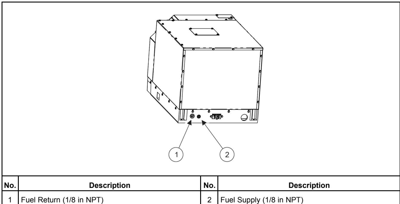
**FIGURE 8. FUEL CONNECTIONS**
