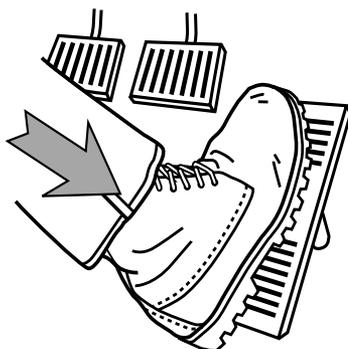
Cuando cambia de velocidad, el freno de motor se desactiva automáticamente cuando pisa el pedal de embrague.
