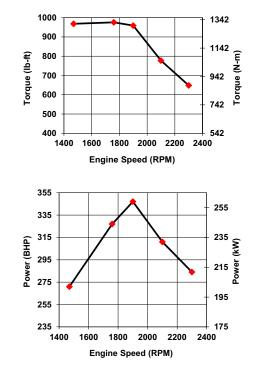
**Horsepower Output** RPM BHP kW 1470 271 202 1760 327 244 1900 347 259 2100 311 232 2300 284 212
